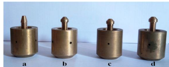
Fig. 2: Conical valve a) 30^0 b) 45^0 c) 60^0 d) 90^0
